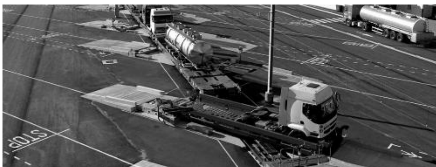
Chargement d'un camion sur un wagon Modalohr.
