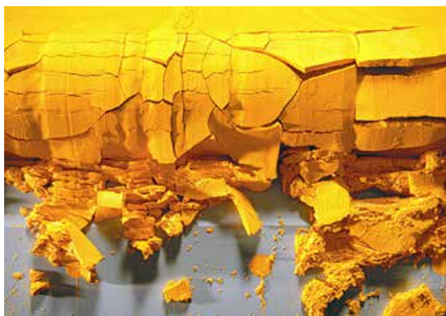
Yellow Cake | Concentré solide d'uranium après extraction et traitement de l'uranium naturel
